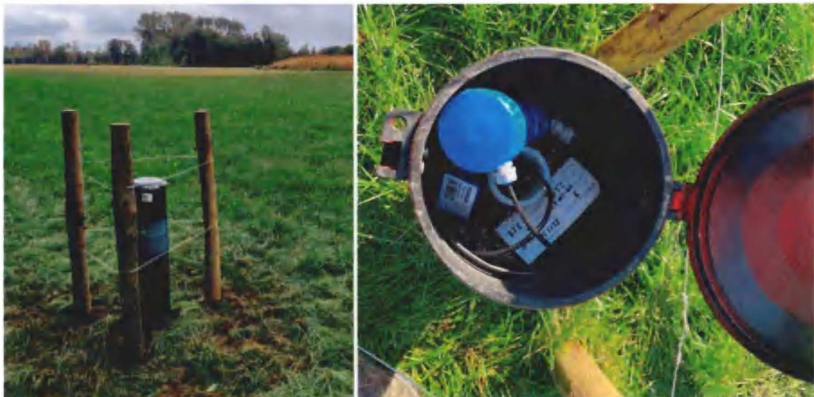
Foto 5 Peilbuis afgewerkt met mantelbuis en voorzien van meetapparatuur, foto VCM!
