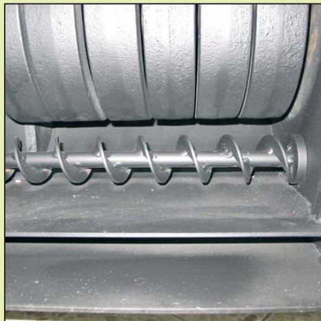
**U**m aber einen Gussrost einsetzen zu können, der alle Voraussetzungen für eine optimale Holzvergasung mitbringt, musste dieser in einzelne Scheiben unterteilt werden. Um die totale Verbrennung des Brenngutes zu garantieren, darf der Rollrost nicht gekühlt werden, was eine enorme Belastung bedeutet, die unser Rollrost aber mühelos meistert.
