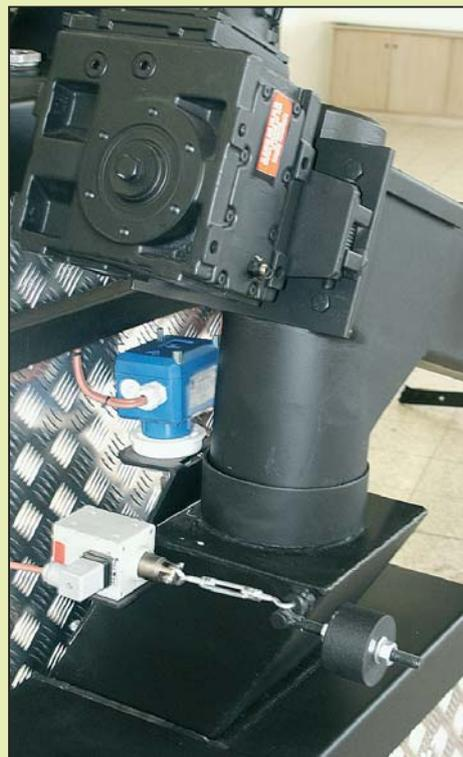
Der Füllstandsmelder ist für die richtige Füllmenge zuständig
