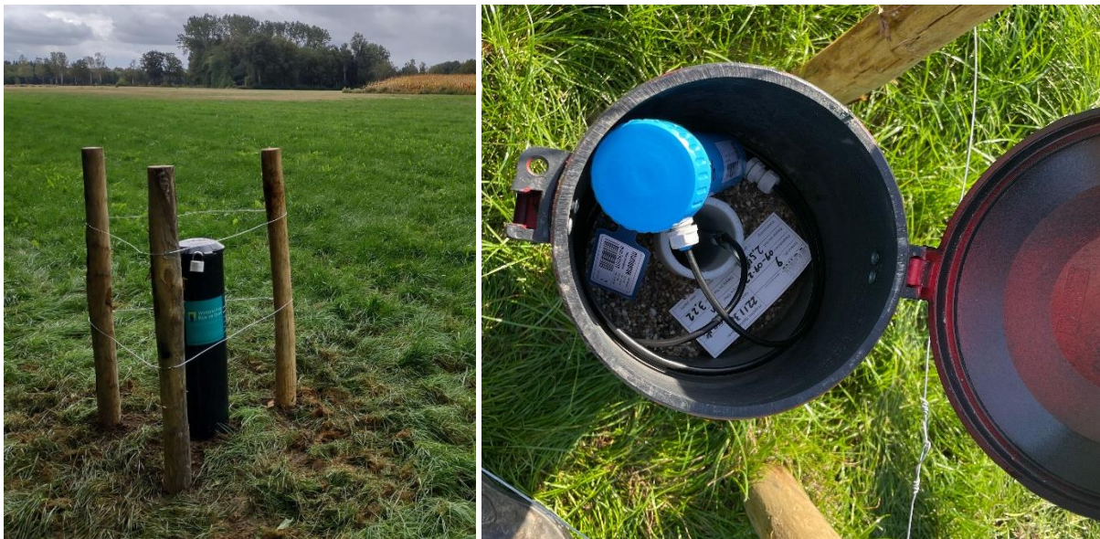
Foto 5 Peilbuis afgewerkt met mantelbuis en voorzien van meetapparatuur, foto VCMI
